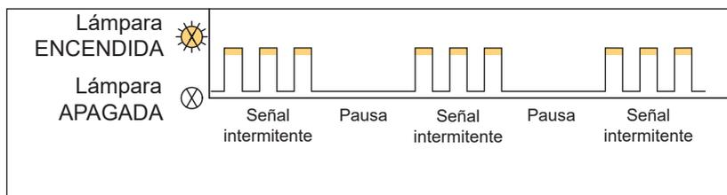
Cada error parpadea tres veces seguidas. Si hay dos o más fallos, estos parpadearán sucesivamente. Para repetirlos, girar la llave de arranque a la posición "0" y, a continuación, volver a girarla a la posición "I". Si el error deja de aparecer en dos ciclos de operación (= arranque/servicio/parada) se el código de parpadeo se apagará automáticamente.
